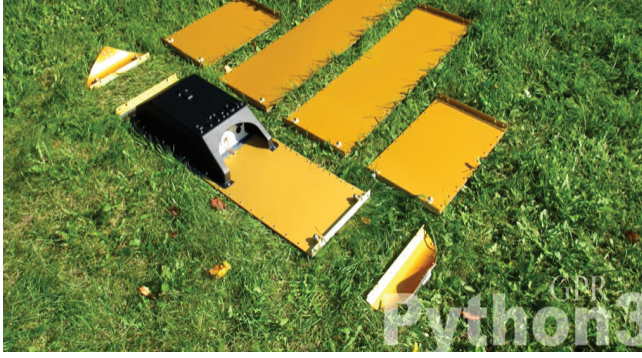
Şekil 7. Zond Python 3 GPR Mhz Merkez Anteni 1
