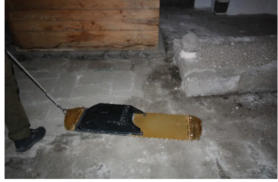
Şekil 8. Türbelerdeki Taramalarda Kullanılan Python-3 GPR Cihazı
